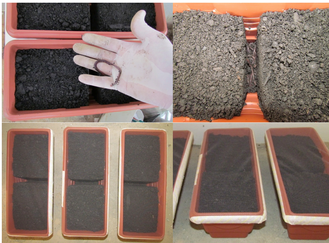
Figura 52. Fotos da montagem e condução do experimento de comportamento de fuga. (1) Figuras na parte superior: Introdução das minhocas no espaço entre solo tratado e não tratado. (2) Figuras da parte inferior: Experimento em andamento.
