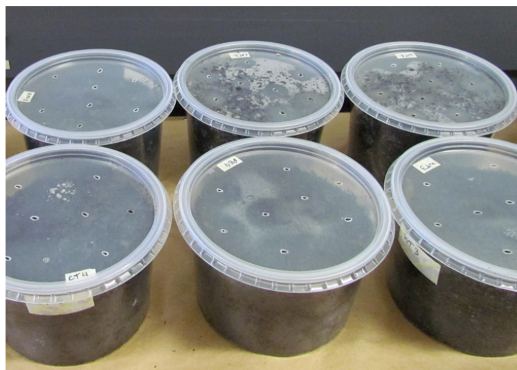
Figura 48. Recipientes utilizados nos experimentos de ecotoxicidade aguda. Detalhe para as tampas perfuradas permitindo troca gasosa.
