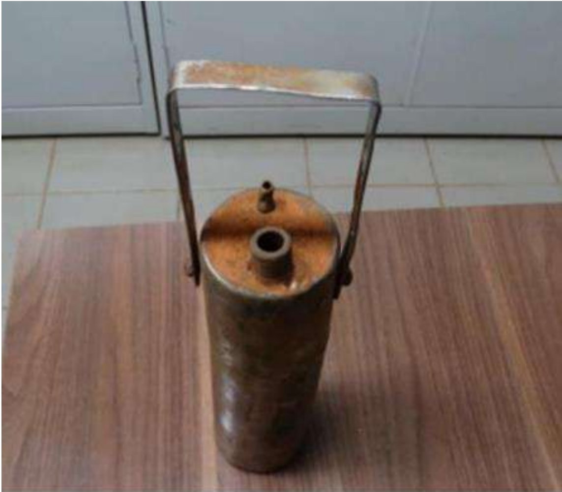
Figura 16 – Amostrador encontrado dentro do tanque.
