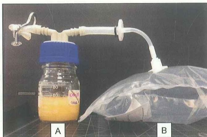
Figura S 4: Sistema para coleta de gases e quantificação da produção de CO 2 . Garrafa adequada para fermentação (A) acoplada a uma bag apropriada para coleta dos gases produzidos.
